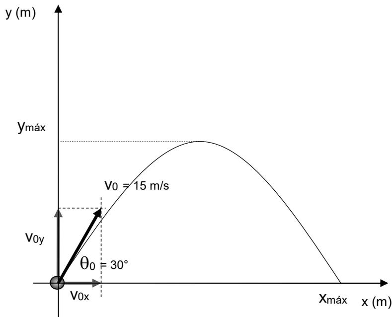
En esta figura se representa la trayectoria de la pelota. No necesariamente debe ser realizada a escala, simplemente es un croquis que nos ayuda a comprender mejor el enunciado. Colocamos los ejes de referencia en el punto de partida de la pelota de modo que  $y_0 = 0$  (m) y  $x_0 = 0$  (m).
